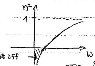
הפרק של L-Wave (המורה על כיוון הפרק) :  $\omega = \frac{1}{2} (-\omega_c + \sqrt{\omega_c^2 + 4\omega_p^2}) > 0$
